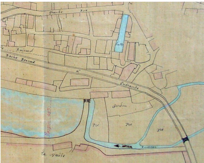
extrait du plan de 1840 (AD56 S174) avec le projet de tracé de la nouvelle route et la création d'un ouvrage de franchissement au dessus du ruisseau.
